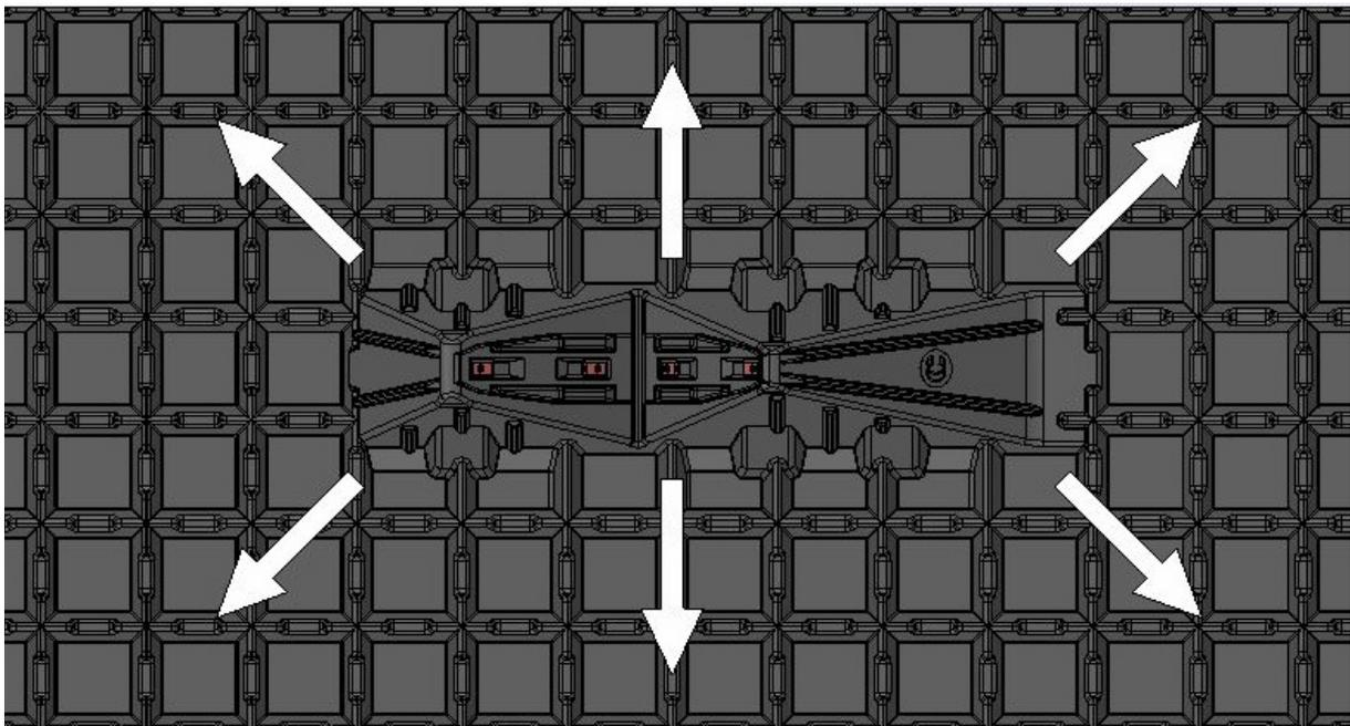
Bei dem Schüttvorgang ist darauf zu achten, dass kein Kies/Granulat unter die Basisplatte gelangt, dieses ist gegebenenfalls zu entfernen. Die Klemmmuttern sind zwingend sauber zu halten.
