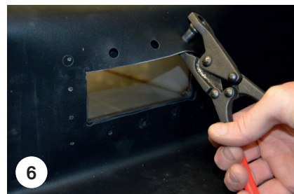
6 Poinçonnez les trous marqués avec une poinçonneuse de 10 mm
