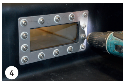
4 Montez le profil extrudé (n'utilisez que les vis à bague d'étanchéité faisant partie de la livraison)
