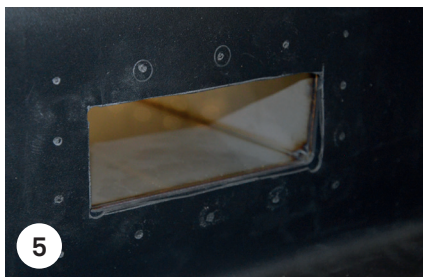
5 Faites une entaille en forme de croix, poinçonnez les extrémités découpées, finissez de découper à angle droit
