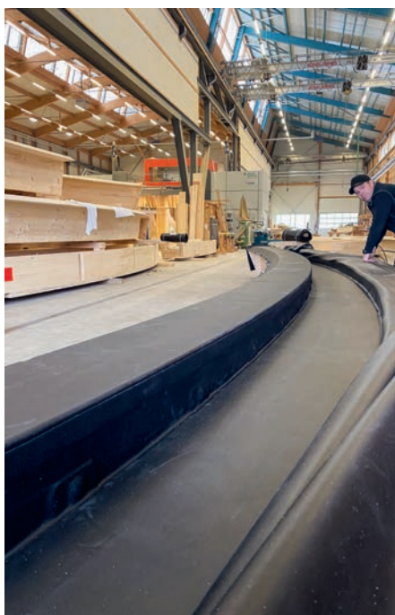
Auskleidung der vorgefertigten Rinnen-Elemente.
